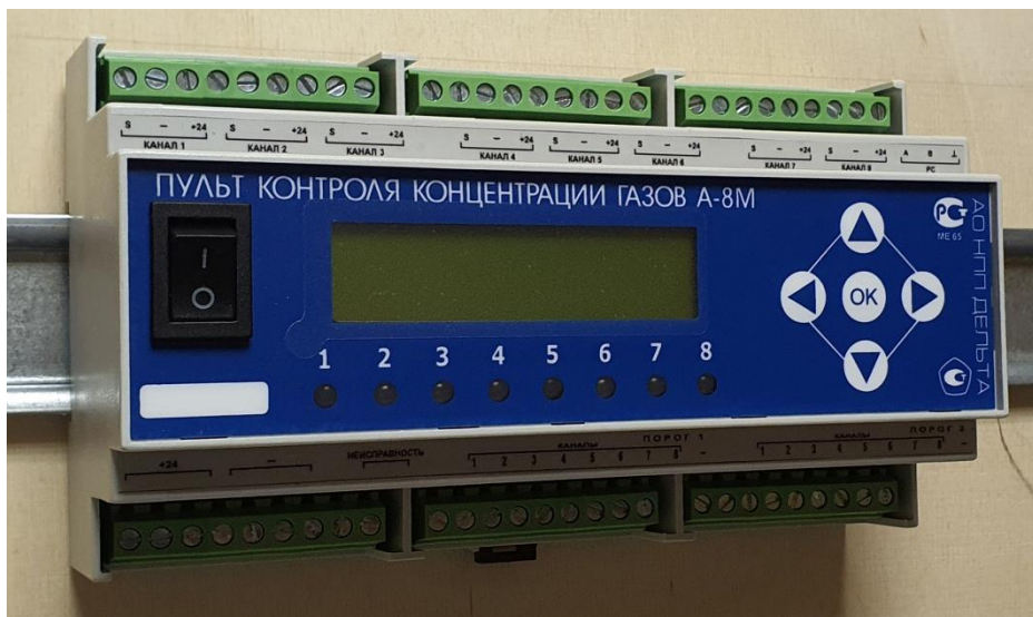
Рис. 4. Внешний вид и габаритные размеры пульта контроля А-8М
