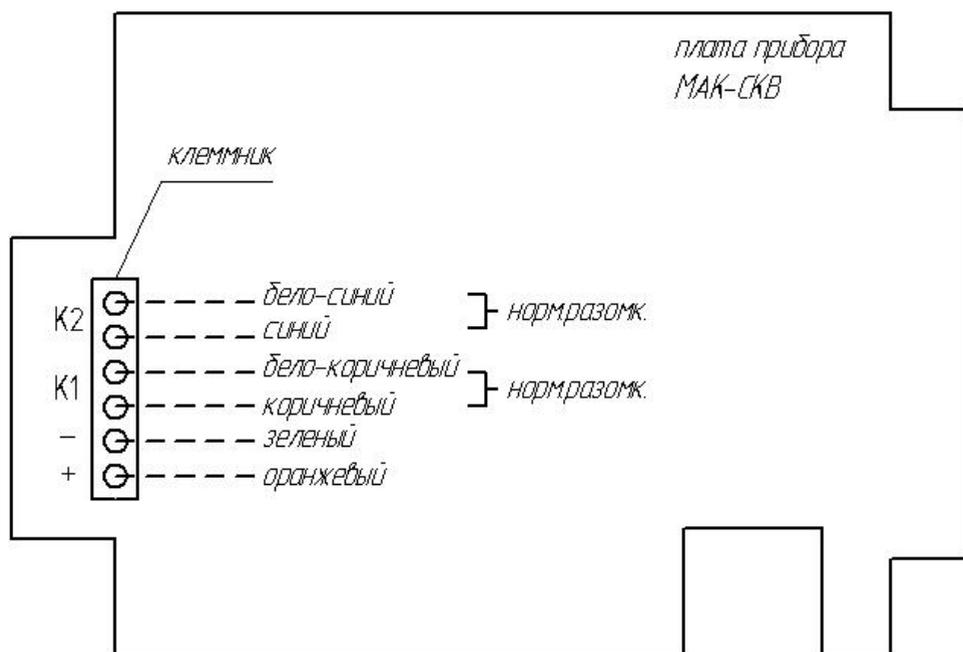
Рис 2. Схема электрических соединений на электронной плате ГС «МАК-СКВ» шлейфового включения.
