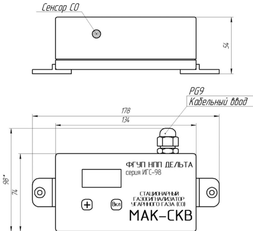
Рис 1. Габаритные размеры ГС «МАК-СКВ» для шлейфового включения.
